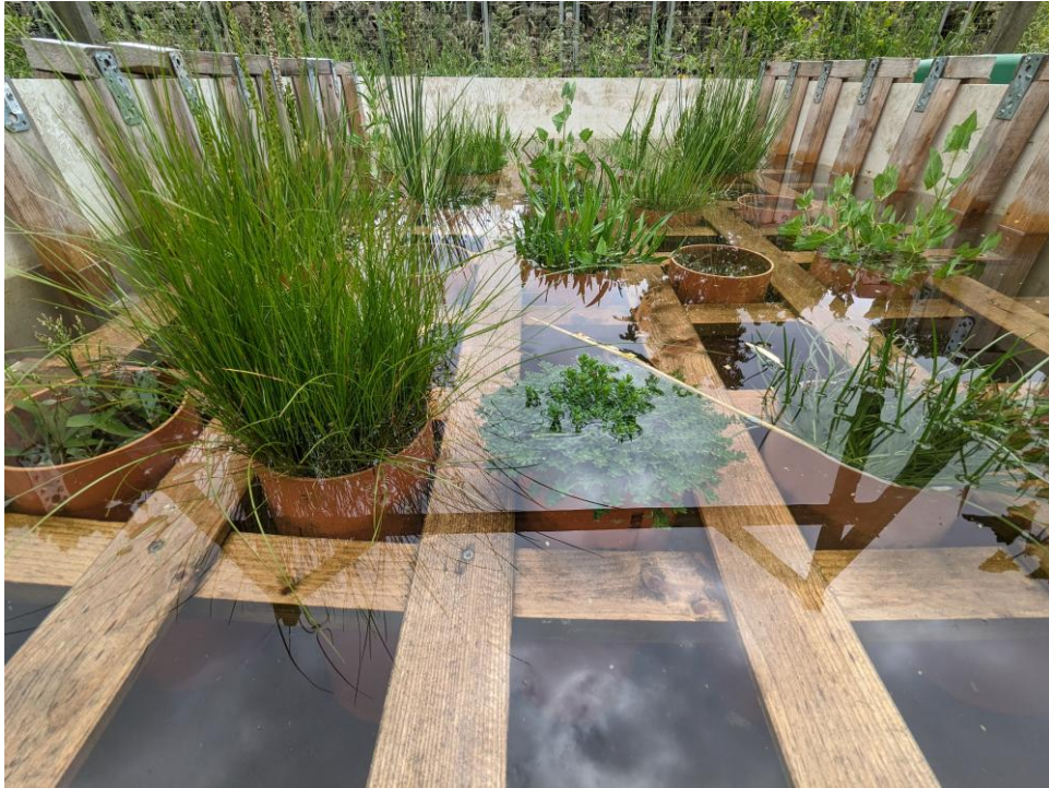
Blick in das Tidebecken-Mesokosmen-Experiment: Töpfe mit typischen Pflanzen aus Nordsee-Salzmarschen in unterschiedlichen Diversitätsstufen unter simulierter Überflutung.
